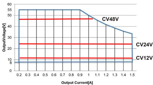
(調光率が 100% の場合、完全な CV 動作になります、調光中は調光率により 8~設定電圧の範囲で変化します。CV 値は任意の値に設定可能)
